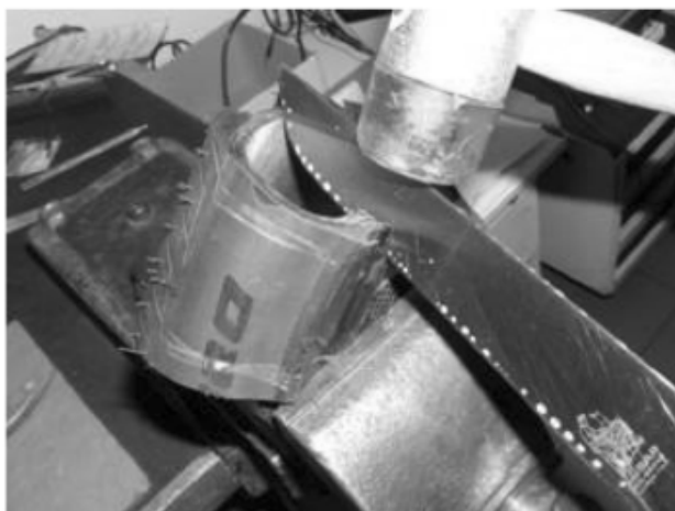
图 B.7 第 2 步:如图 B.2 所示沿切割线 3 切去胎圈钢丝
