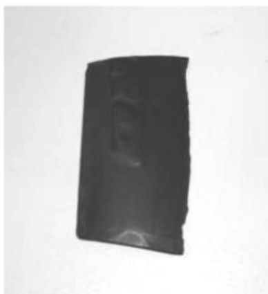
图 B.12 子步骤 2A: 剥去表层胶料后的胎侧胶样品, 可用于分析
