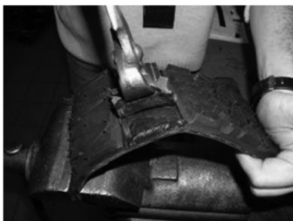
图 B.4 第 1 步:从轮胎上取下一片胎面部分
