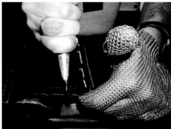
图 B.3 第 1 步:用小刀和切割槽切取胎面部分
