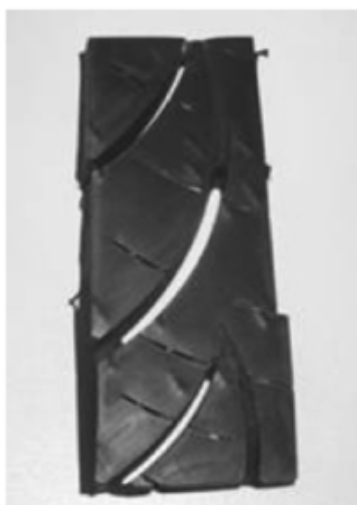
图 B.6 第 1 步:剖去表层胶料后的胎面胶样品,可用于分析
