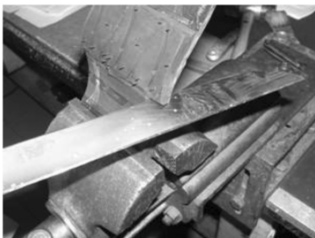
图 B.8 第 2 步:如图 B.2 所示沿切割线 1 切去胎侧部分
