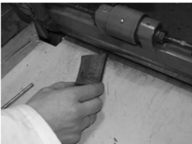
图 B.11 子步骤 2A:胎侧部分的表层借助剖片机处理以获得干净的胎侧样品
