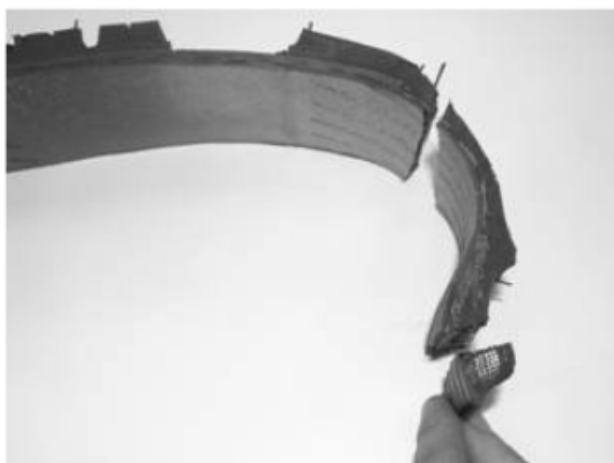
图 B.9 第 2 步:切去胎面和胎圈钢丝后的胎侧部分
