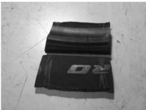
图 B.10 子步骤 2A:如图 B.2 所示沿切割线 2 切去后的胎侧部分
